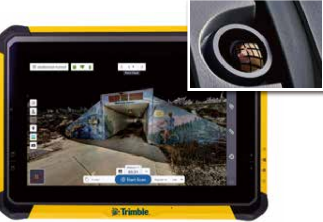
現場で色付けされた 3次元点群
